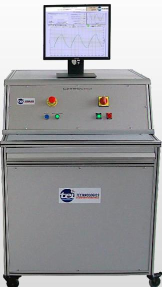
Le Banc d'essai pression cyclée BPCV3 permet de réaliser des tests de cyclage en pression et dépression sur des équipements aéronautiques ou automobiles. Il est utilisé en Production ou R&D pour qualifier des équipements en fatigue jusqu'à l'éclatement en les soumettant à une pression cyclique définie.
