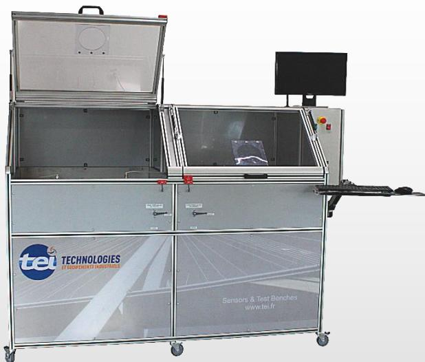
Le Banc de pression cyclée 10Hz est destiné aux laboratoires et Services Essais souhaitant soumettre en parallèle plusieurs équipements (carter, vannes, tuyauteries etc.) à un test d'endurance prolongé (jusqu'à 10 millions de cycles) à fréquence élevée.
