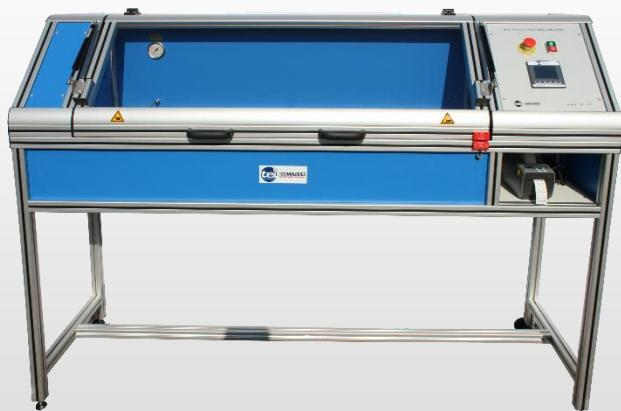
Le Banc de test pour Flexibles aéronautiques permet aux Ateliers MRO de réaliser de manière semi-automatique des tests d'épreuve et de fuite à l'eau sur de nombreux flexibles.
