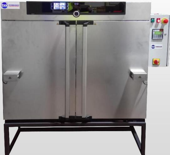
Ce banc permet de réaliser à haute température des tests d'éclatement en enceinte climatique à l'air sur des pièces industrielles.
