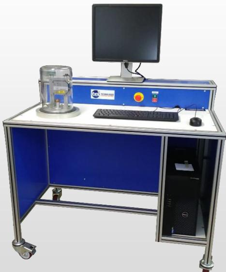
Ce banc de test est destiné aux OEM ou laboratoires d'essais souhaitant tester et qualifier des capsules altimétriques. Il permet de mesurer avec précision la déformation mécanique d'un élément sensible sous différentes pressions.
