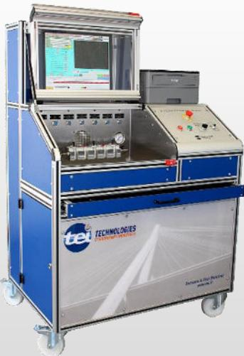
Le banc d'essais Pressostats Skydrol est destiné aux OEM et ateliers MRO souhaitant tester et contrôler des interrupteurs de pression, pressostats et manostats hydrauliques avec du Skydrol.
